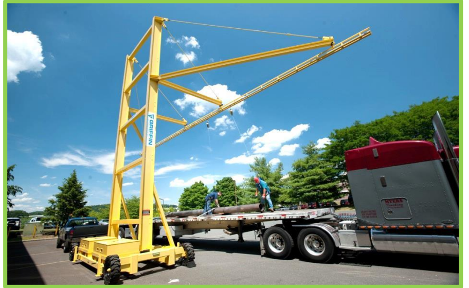
Şekil 5.5. Araç üzerinde düşmeye karşı koruma [32]
